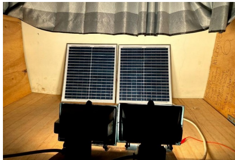
Gambar 5. Dua Modul PV Menggunakan Sumber Cahaya Dua Lampu Halogen
