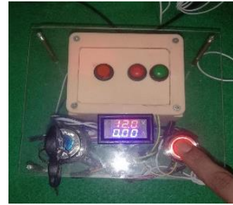
Gambar 6 pengujian memasukkan sidik jari dengan kondisi basah
