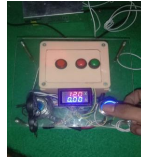
Gambar 5 Pengujian memasukkan sidik jari dengan kondisi kering
