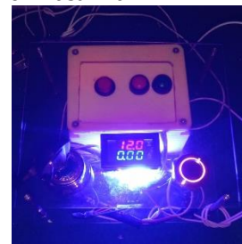
Gambar 7 Percobaan sensor penguncian relay setelah sidik jari berhasil di masukkan
