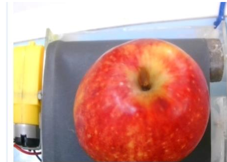
Gambar 17 Data Hasil Tangkapan Webcam Apel Matang Pada Pencahayaan 551 Lux
