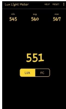
Gambar 15 Pengukuran Intensitas Cahaya Sebesar 551 Lux.
