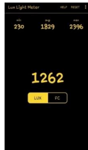
Gambar 18 Pengukuran Intensitas Cahaya Sebesar 1262 Lux.
