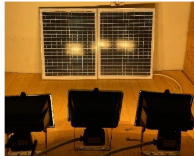
Gambar 5. Dua Modul PV Menggunakan Sumber Cahaya Tiga Lampu Halogen
