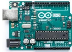
Gambar 11. Arduino Uno R3
