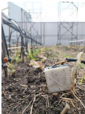
Gambar 8. Implementasi Sensor Kelembaban Tanah
