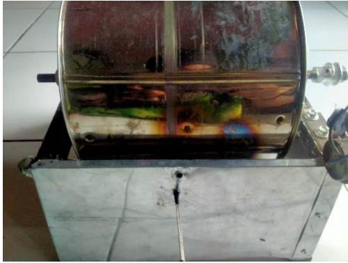
Gambar 4. Sensor termokopel pada tabung sangrai
