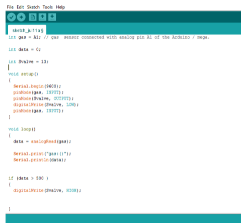
Gambar 3.2 pengaturan pin atmega 2650 untuk mengontrol relay
