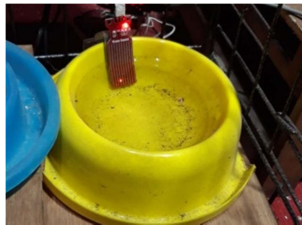
Gambar 8 water level sensor berada di wadah minum kucing
