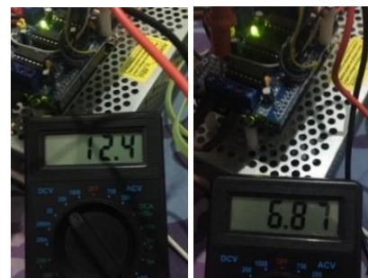
Gambar 5. Pengujian Output Tegangan dan Arus Driver Motor
