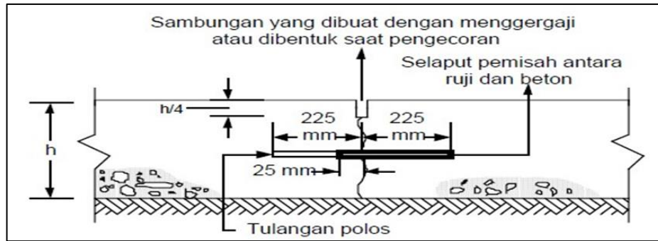
Gambar 4. Sambungan susut melintang dengan ruji (Sumber: Anonim, 2003)
