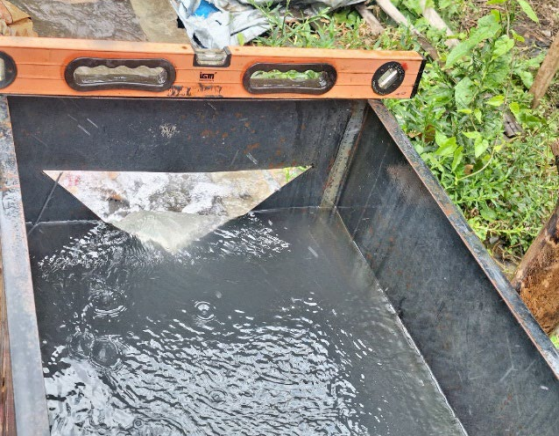
Gambar 4.1 Debit Air Sumur Bor Sumber: Dokumentasi Penulis, 2025
