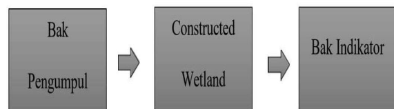
Gambar 4.4. Diagram Alir Unit IPAL
