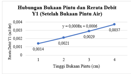
Gambar 9. Hubungan Antara Bukaannya Pintu Air dan Rerata Debit Y1 (Setelah Bukaannya Pintu Air)
