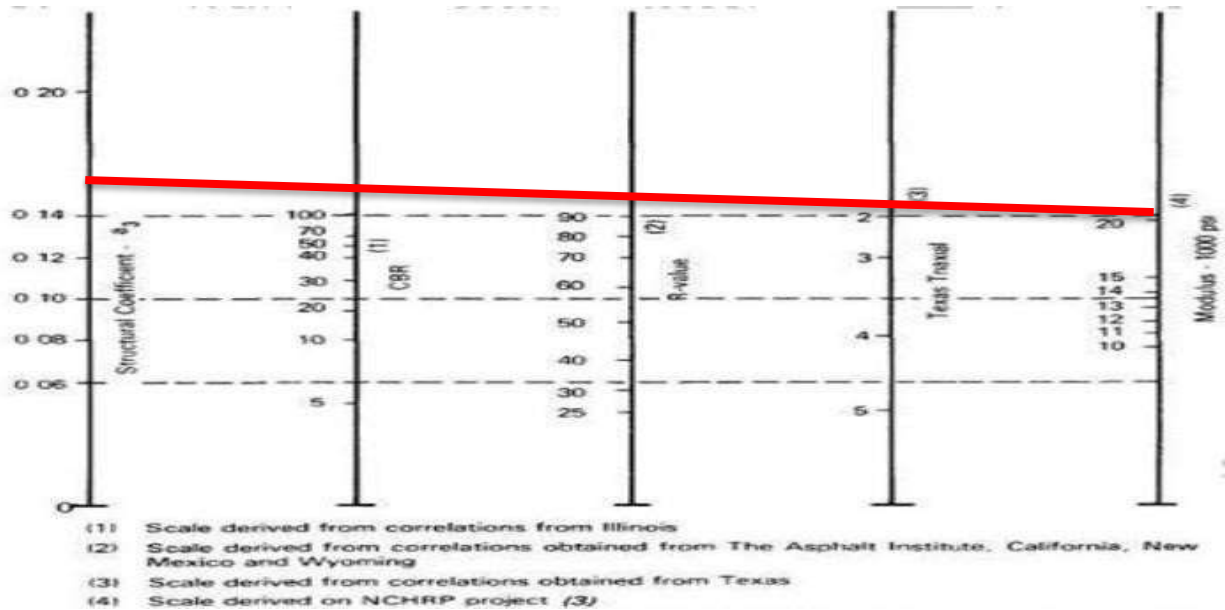
Gambar 4 Grafik Koefisien Kekuatan Relatif Lapis Pondasi Granular a2
